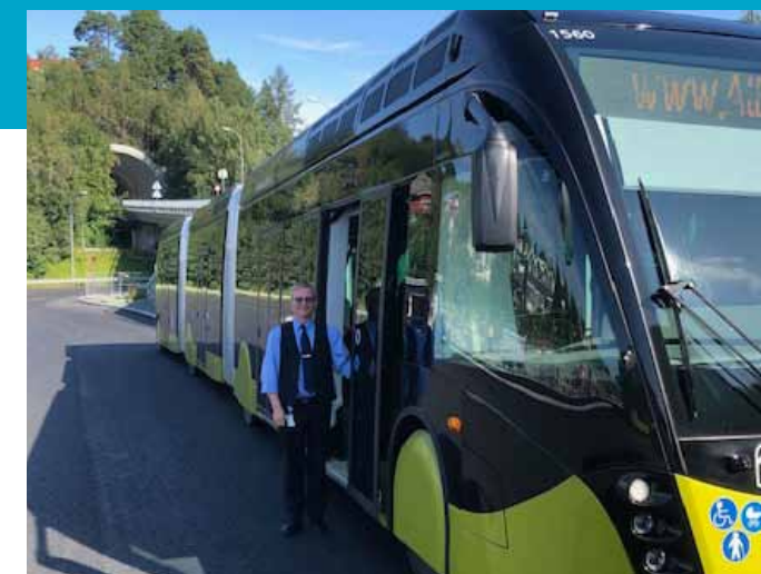
Bussfører Lyng blir liten i forhold til bussens 24m. Til sammenlikning er vanlig leddbuss 18,6m, normal 2-aksla buss 12m, 3-aksla busser ca 15m og Gråkallbanens trikker 20m.
